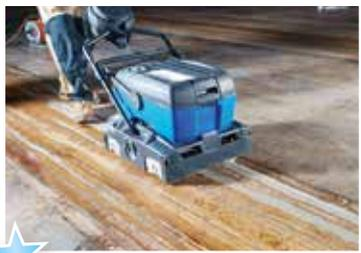
Mit seinen Walzbürsten reinigt der Power Scrubber besonders sanft und gründlich. Wird die Oberfläche mit einer Einscheibenmaschine angeschliffen, kann sie anschließend nachversiegelt oder geölt werden.
